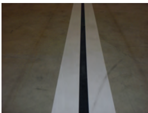
Aufkleber FTS Bahn gerade b=160mm l=3m
