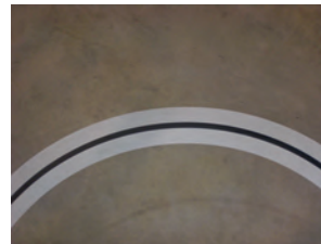
Aufkleber FTS Bahnkurve 90° b=160mm r=1m
